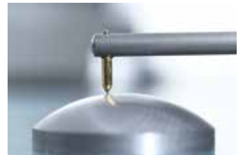
Рождение алмаза. Сверху: каждый купол точно обрезается лазером для удаления каких-либо неравномерностей с поверхности и для соблюдения постоянства формы. Справа: комплект готовых куполов, уже с защитным платиновым покрытием.
